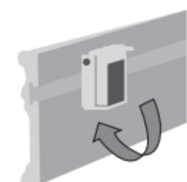
Insertar clip magnético de forma horizontal dentro del canal de la galería y girar hasta que quede alineado verticalmente.
