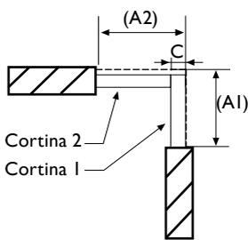
**Montaje en Esquina:** Para la cortina 1, medir el ancho A1. Para la cortina 2, medir el ancho A2 y reste según la tabla:
