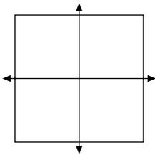
**Fuera de Vano:** Mida el ancho y el alto deseado en el centro de la ventana. Se recomienda añadir 100 mm por lado para minimizar el paso de la luz.
