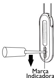
Deslice el tensionador de cordón hasta la parte inferior dé la vuelta de cordón. Inserte un pequeño destornillador dentro del agujero en la parte de abajo del tensionador. Mueva el destornillador hacia abajo, hasta la marca, donde se libera el mecanismo de seguridad. Deslice el tensionador hasta la vuelta inferior del cordón. Ajuste el tensionador siguiendo las instrucciones adjuntas con el kit de instalación de tensionador de cordón universal.
