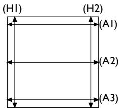
**Dentro de Vano:** Mida el ancho del vano arriba (A1), al medio (A2) y abajo (A3). Escoja el ancho menor. Mida el alto a la derecha (H2) e izquierda (H1) y elija el de menor valor.
